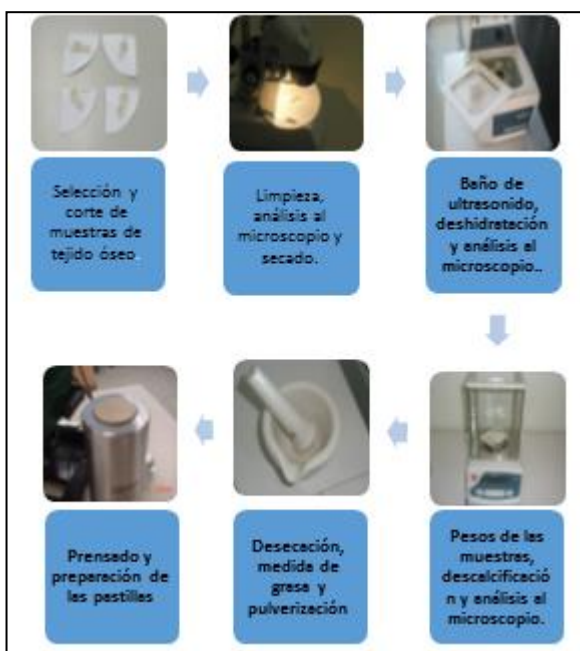
Fig. 1. Diagrama en bloques del procedimiento para la preparación de muestras.
