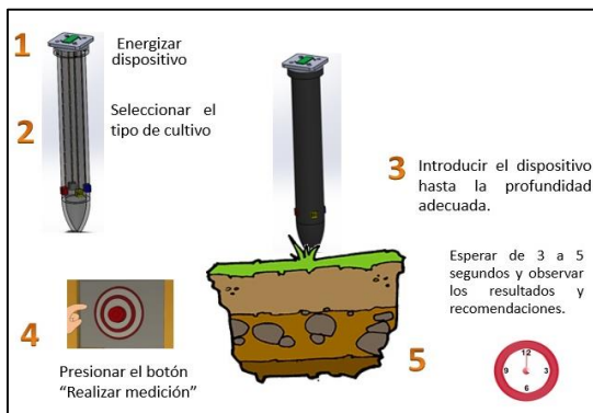
Fig.3 Procedimiento para la medición de Parámetros
