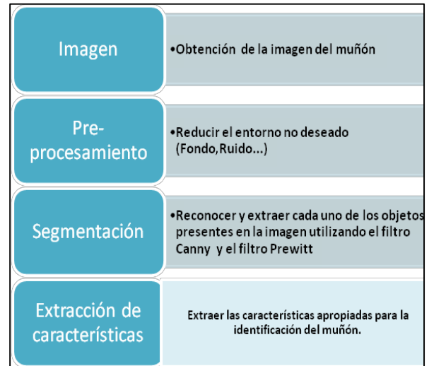
Fig. 6 Diagrama de flujos para el procesamiento de imágenes.
